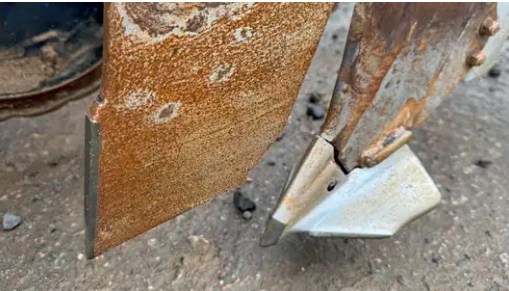
Darbinių dalių su abrazyviniam dilimui atspariomis volframo karbido plokštelėmis ilgesnis ne tik tarnavimo laikas – dėl retesnio jų keitimo, sutrumpinamos agregato prastovos
