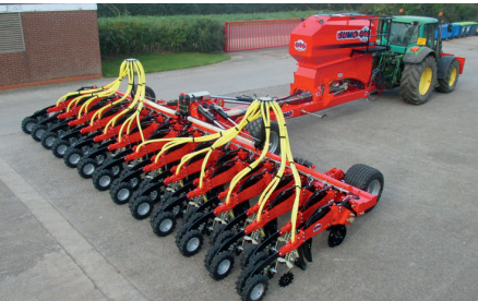
Pirmųjų dviejų sekcijų 9,0 m darbinio pločio DTS sėjamųjų konstrukcija buvo skirta apsisukimo spinduliui galulaukėje sumažinti. Šios „Moore“ dozatorius turinčios sėjamosios rinkoje pasirodė 2011 m., tačiau pirmieji priešserijiniai egzemplioriai pasirodė metais anksčiau. Jungtinėje Karalystėje tokios sėjamosios sutinkamos retai, tačiau žemyninėje Europoje jos prisidėjo didinant DTS sėjamųjų populiarumą
