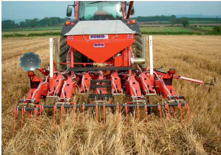
Pirmosios pakabinamos DTS3 sėjamosios prototipo lauko bandymai (nuotrauka viršuje). „Sumo“ inžinieriai DTS sėjamasias konstruoti pradėjo 2007 m., o pirmieji serijiniai egzemplioriai pasirodė tik 2011-aisiais (apačioje). Abejose nuotraukose matyti, kaip keitėsi sėjamosios konstrukcija nuo prototipo iki pirmojo serijinio modelio, juolab, kad DTS sėjamųjų tobulinimas nesustojęs – jos modifikuojamos ir toliau
