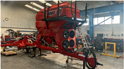
Pirmosios prikabinamos DTS sėjamosios buvo siūlomos su 3 000 l talpos bunkeriu. Netrukus kaip pasirenkama įranga pradėtas siūlyti didesnis, 3 600 l talpos bunkeris. Nuo 2024 m. 4,0 m ir platesnėse sėjamosios galimos ir su 5 000 l talpos bunkeriu
