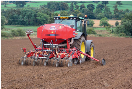
Pirmosios pakabinamos DTS3 sėjamosios prototipo lauko bandymai (nuotrauka viršuje). „Sumo“ inžinieriai DTS sėjamasias konstruoti pradėjo 2007 m., o pirmieji serijiniai egzemplioriai pasirodė tik 2011-aisiais (apačioje). Abejose nuotraukose matyti, kaip keitėsi sėjamosios konstrukcija nuo prototipo iki pirmojo serijinio modelio, juolab, kad DTS sėjamųjų tobulinimas nesustojęs – jos modifikuojamos ir toliau
