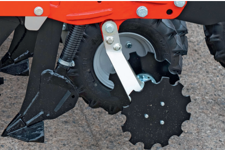
Sudėtingos konstrukcijos dvidiskių reguliuojamų užžertuvų laikikliai (nuotrauka viršuje) 2016 m. buvo pakeisti standesniais vientaisiais laikikliais (apačioje). Ankstesnius laikiklius galima pakeisti naujaisiais. Patys diskai gali būti lygiai arba karpymais asmenimis. Pastarieji sutinkami dažniau
