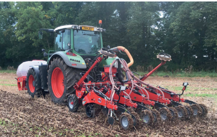
3,0 m darbinio pločio DTS rėmas su sėjamosiomis sekcijomis yra specialiai pritaikytas traktoriaus priekyje pakabinamam bunkeriuvi. Jis buvo pristatytas 2014 m. Jungtinėje Karalystėje, skirtingai nei žemyninėje Europoje, tokia konfigūracija netapo populiaria
