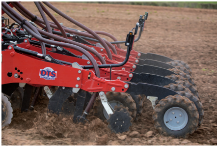
Iki 2017 m. padanginiai atraminiai, gylio reguliavimo ratai buvo bazinėje įrangoje, vėliau jie tapo pasirenkami
