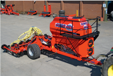
2013 m. pristatytoje DTS3 sėjamosios prototipe su mineralinių trąšų įterpimu pirmą kartą sumontuoti „Sumo Orga“ dozatoriai ir slėginis bunkeris. Rinkoje toks sėjamosios modelis pristatytas 2014-aisiais (nuotrauka dešinėje)
