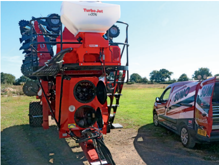
Maždaug nuo 2022 m. pradėta siūlyti pasirenkama gamyklinė „Stocks TurboJet I-con“ smulkių sėklų ir mikrogranulių įterpimo įranga. Iki 4,0 m darbinio pločio sėjamosiose mažasis bunkeris su dozatoriumi pritvirtinamas virš sėjamųjų sekcijų, o 6,0 m ir platesnėse sėjamosiose – pagrindinio bunkerio priekyje
