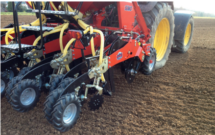
Pirmuosiuose rėmuose su sėjamosiomis sekcijomis, pastarosios buvo išdėstytos mažesniu žingsniu (nuotrauka viršuje). Esant dideliame augalinių liekanų kiekiui, taip išdėstyti noragėliai greičiau pradėti kimštis. 2015 m. atliktas patobulinimas – pradėti naudoti laikiklių prailginimai, padidinantys žingsnį tarp atskirų sekcijų. Tokiu būdu gretimi noragėliai išdėstyti labiau šachmatiškai. Naujaisiose sėjamosiose naudojami pakeistos konstrukcijos noragėliai ir kotų laikikliai (nuotrauka apačioje). O anksčiau pagamintoms sėjamosioms siūlomi laikiklių prailginimai, leidžiantys padidinti žingsnį tarp gretimų eilių noragėlių
