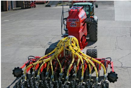
2013 m. pristatytoje DTS3 sėjamosios prototipe su mineralinių trąšų įterpimu pirmą kartą sumontuoti „Sumo Orga“ dozatoriai ir slėginis bunkeris. Rinkoje toks sėjamosios modelis pristatytas 2014-aisiais (nuotrauka dešinėje)
