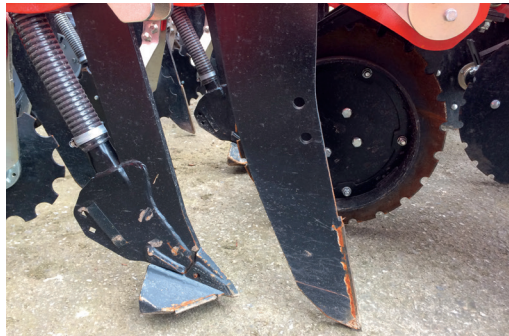
Pirmosios laidos sėjamosiose kotų ir noragėlių išdėstymas (nuotrauka kairėje) lėmė greitesnį jų užsikimšimą augalinėmis liekanomis. 2016 m. pakeitus kotų ir noragėlių profilius problemą pavyko išspręsti. Atnaujintas darbinės dalis taip pat galima sumontuoti ankstesnėse DTS sėjamosiose
