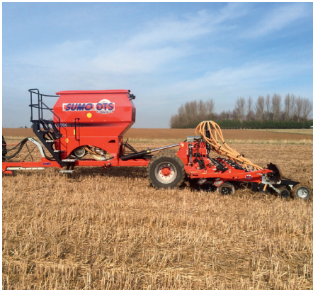
Siekiant sumažinti darbinių dalių dėvėjimąsi ir supaprastinti sėjamosios paruošimą darbui (vėlgį, dėl neteisingų reguliavimų, didėja darbinių dalių dėvėjimas). 2016 m. galutinai atsisakyta teleskopinės vilkimo sijos
