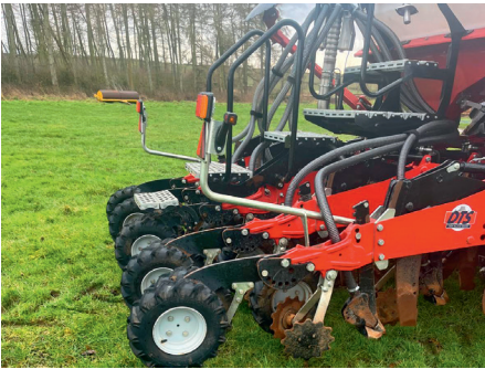
Pirmuosiuose rėmuose su sėjamosiomis sekcijomis, pastarosios buvo išdėstytos mažesniu žingsniu (nuotrauka viršuje). Esant dideliame augalinių liekanų kiekiui, taip išdėstyti noragėliai greičiau pradėti kimštis. 2015 m. atliktas patobulinimas – pradėti naudoti laikiklių prailginimai, padidinantys žingsnį tarp atskirų sekcijų. Tokiu būdu gretimi noragėliai išdėstyti labiau šachmatiškai. Naujaisiose sėjamosiose naudojami pakeistos konstrukcijos noragėliai ir kotų laikikliai (nuotrauka apačioje). O anksčiau pagamintoms sėjamosioms siūlomi laikiklių prailginimai, leidžiantys padidinti žingsnį tarp gretimų eilių noragėlių
