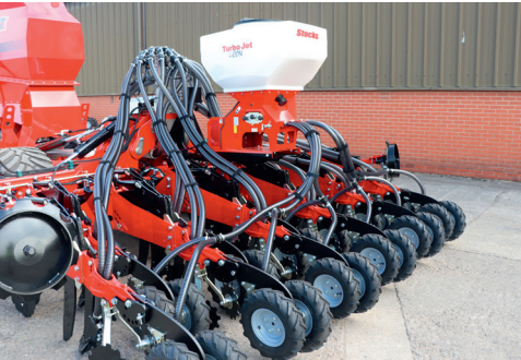
Maždaug nuo 2022 m. pradėta siūlyti pasirenkama gamyklinė „Stocks TurboJet I-con“ smulkių sėklų ir mikrogranulių įterpimo įranga. Iki 4,0 m darbinio pločio sėjamosiose mažasis bunkeris su dozatoriumi pritvirtinamas virš sėjamųjų sekcijų, o 6,0 m ir platesnėse sėjamosiose – pagrindinio bunkerio priekyje
