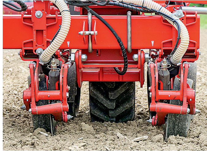
Naujų viendiskinių tręšiamųjų noragėlių skersmuo 381 mm, trąšų įterpimo gylis reguliuojamas šoniniu atraminiu ratuku
