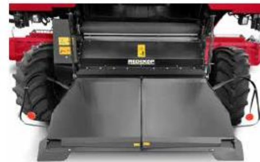
Xtra smulkinimo sistema su atskirais paskleidimo skydais
