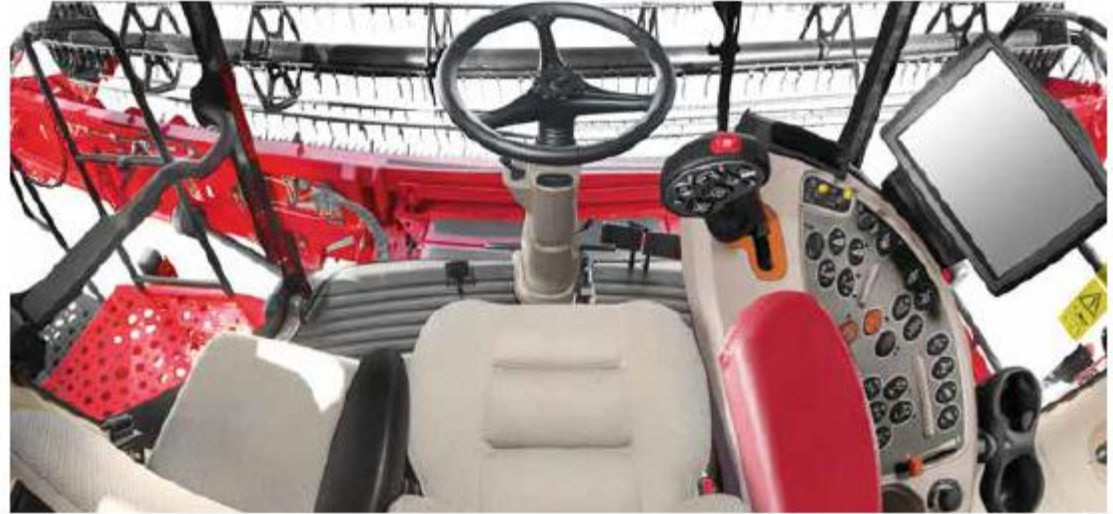
Patogi kabina, pilnas pjaunamosios matomumas ir ergonomiškai išdėstyta valdymo konsolė
