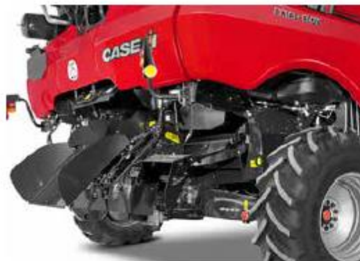
Šiaudų dalytuvas su įvairiomis paskleidimo galimybėmis; šiaudų skleidimo plotis iki 14 m
