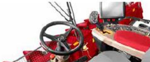
Atlenkiama vairo kolonėlė su naujuoju avariniu jungikliu ir teleskopiškai ištraukiamu vairu – neriboja matomumo
