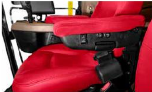
Sėdynė su oro amortizatoriais arba ventiliuojama, šildoma, pusiau aktyvi odinė sėdynė su valdikliais, užtikrinanti prabangų vairuotojo komforto pojūtį
