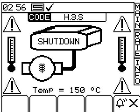
**H.3.S SEED MOTOR MODULE TEMPERATURE SHUTDOWN**
