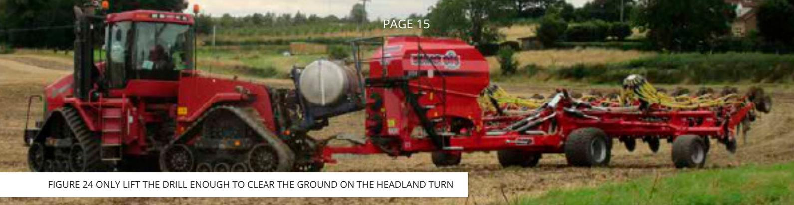
FIGURE 24 ONLY LIFT THE DRILL ENOUGH TO CLEAR THE GROUND ON THE HEADLAND TURN
