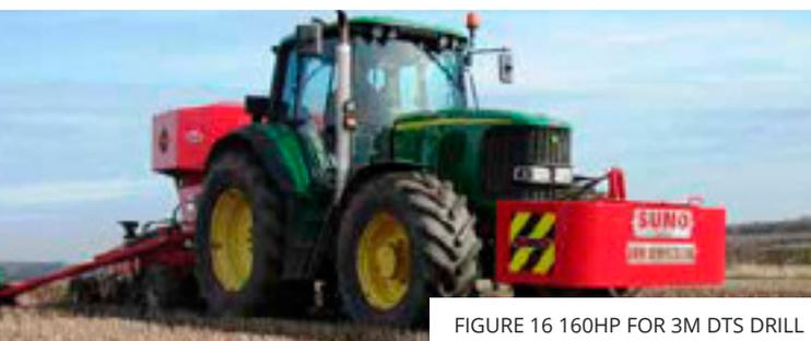
FIGURE 16 160HP FOR 3M DTS DRILL
