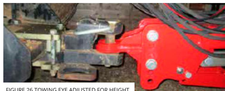
FIGURE 26 TOWING EYE ADJUSTED FOR HEIGHT
