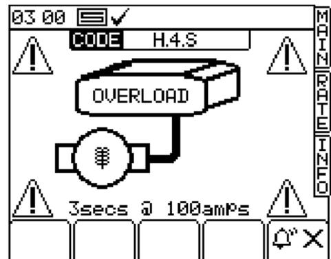
**H.4.S SEED MOTOR MODULE OVERLOAD SHUTDOWN**
