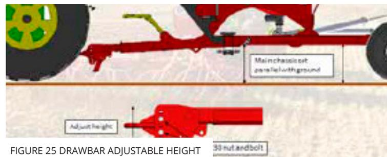
FIGURE 25 DRAWBAR ADJUSTABLE HEIGHT
