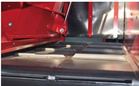
SILOKING skersinis juostinis transporteris ir ant jo esantys skirtingo aukščio skersiniai užtikrina dar didesnį maišytuvo našumą ir patikimesnį darbą.
