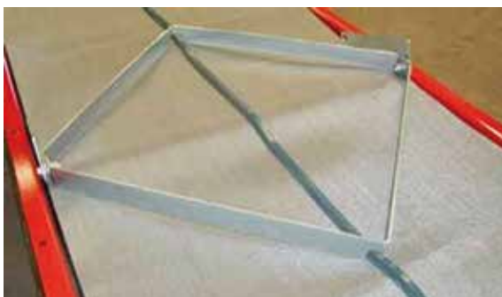
Rombo formos vidinis grandiklis nuvalo transporterio diržą ir užtikrina ilgą eksploataavimo laikotarpį.
