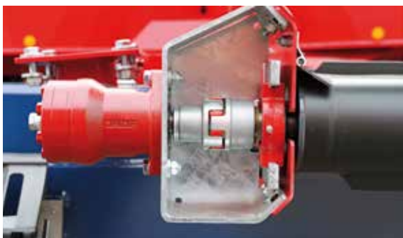
Tarp hidro variklio ir pavaros ritinio įrengta mova užtikrina tolygų darbą ir ilgą eksploataavimo laikotarpį.
