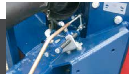
Hidraulinis 2 greičių pavarų dėžės pejungimas.
