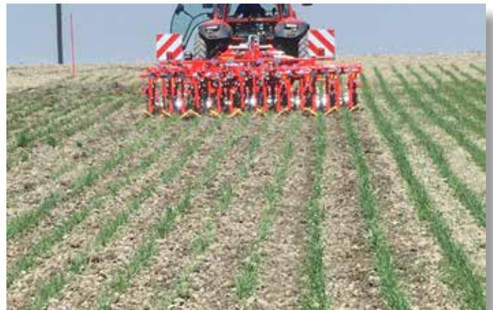
Naudojant tarpueilių kultivatorių, galima pašalinti piktžoles tarp augalų, o kartais (naudojant rotacines akėčias) ir tarp augalų eilėse
