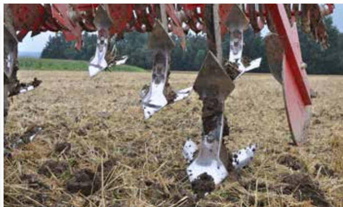
Sparnuoti ir dvigubos širdelės formos noragai ant tvirtų kotų
