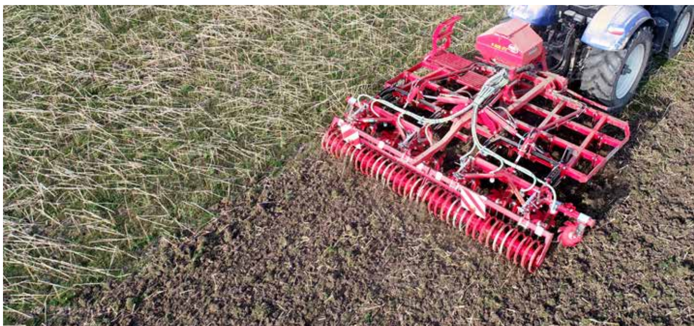
Seklus iššalusių tarpinių pasėlių įmaišymas pavasarį, naudojant universalų skutiką.
