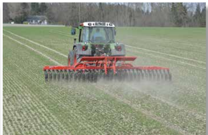
Rotacinės akėčios leidžia suskaidyti dirvožemio plūną visame darbiniam plote
