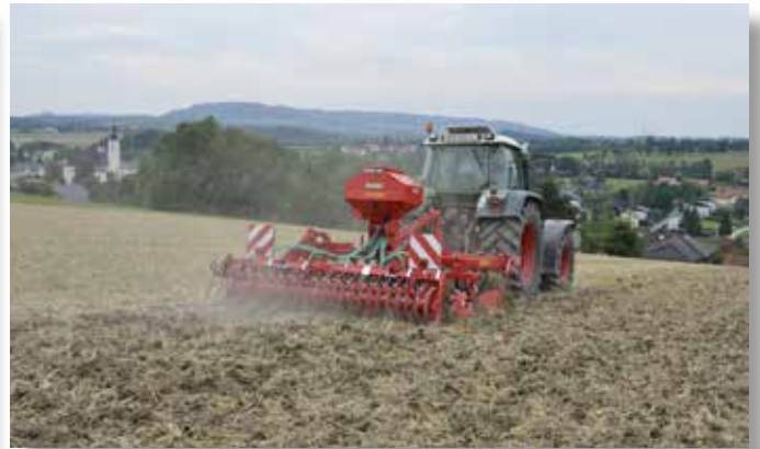
Antrasis ražienų skutimas važiuoim (darbinis gylis maždaug iki 10 cm), kartu su žaliųjų trąšų sėjimu
