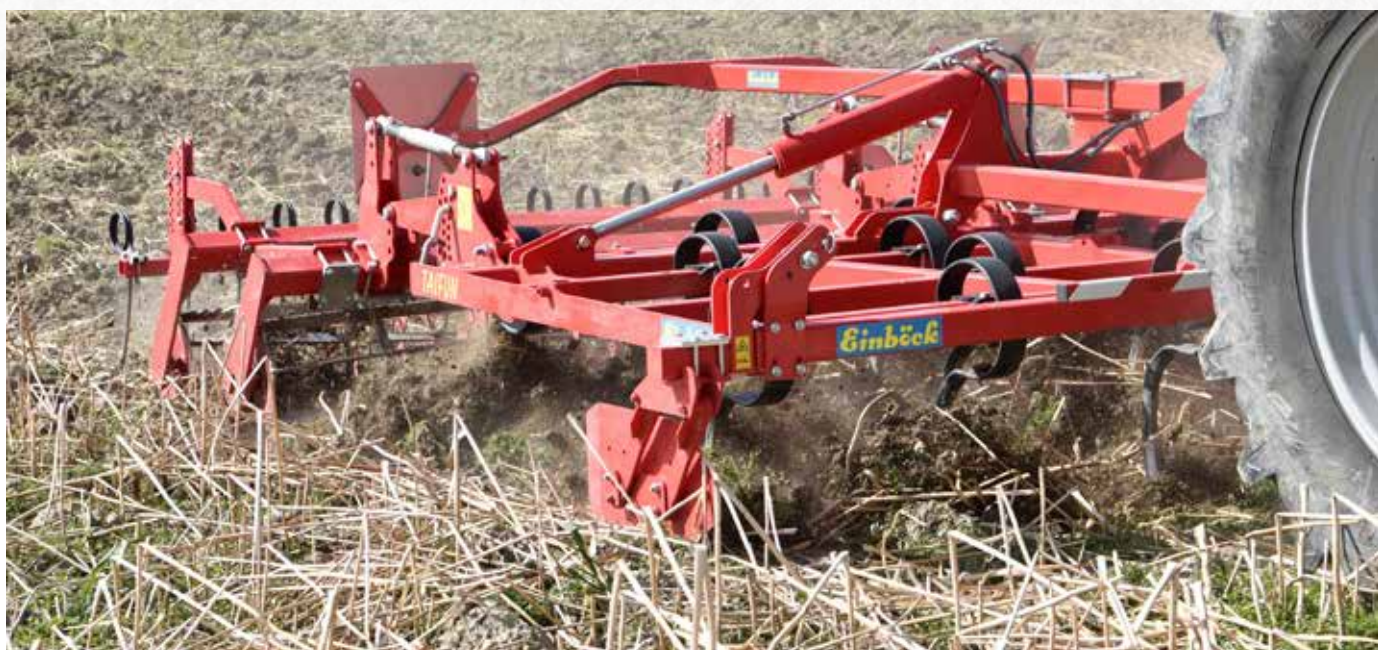
Seklus sušalusių tarpinių pasėlių įmaišymas pavasarį, naudojant lengvą skutiką.
